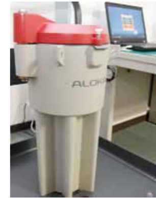
▲給食と食品は食品放射能システムCAN-OSP-NAI 日立アロカメディカル(株)社製で測定しています。
