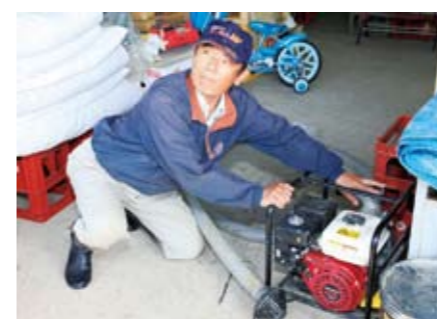
▲排水を汲み上げるポンプ
