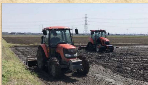
ロボットトラクターとの協調運転作業
