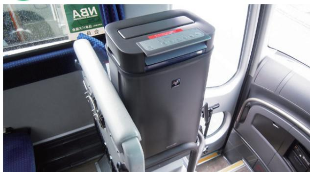
空气中に浮遊したウイルスを不活性化させる効果があるといわれているプラズマクラスター25000の発生装置を高速バス全車両に設置しています。
