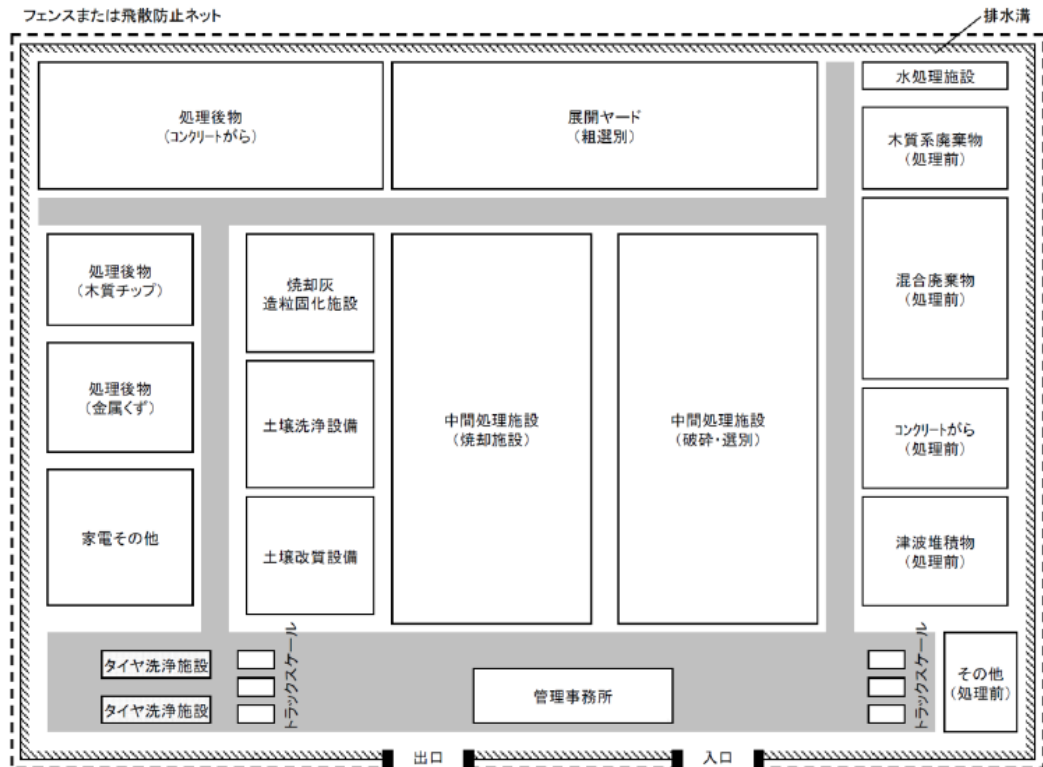
図 2-2-4 二次仮置場のレイアウト例
